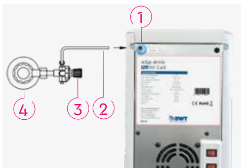
Fig. 8: Ligar a garrafa de gás comprimido de CO 2
