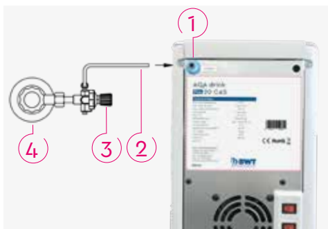
Abb. 8: CO 2 -Druckgasflasche anschließen
