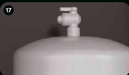
Установите кран на накопительную емкость. Оберните резьбу двумя-тремя слоями ленты ФУМ (приобретается отдельно) для герметизации. Рукой заверните кран до упора.
