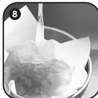
**8** Промойте смолу в течение 30 секунд теплой водой (не выше 40 °С), помешивая, чтобы удалить остатки соленой воды.
